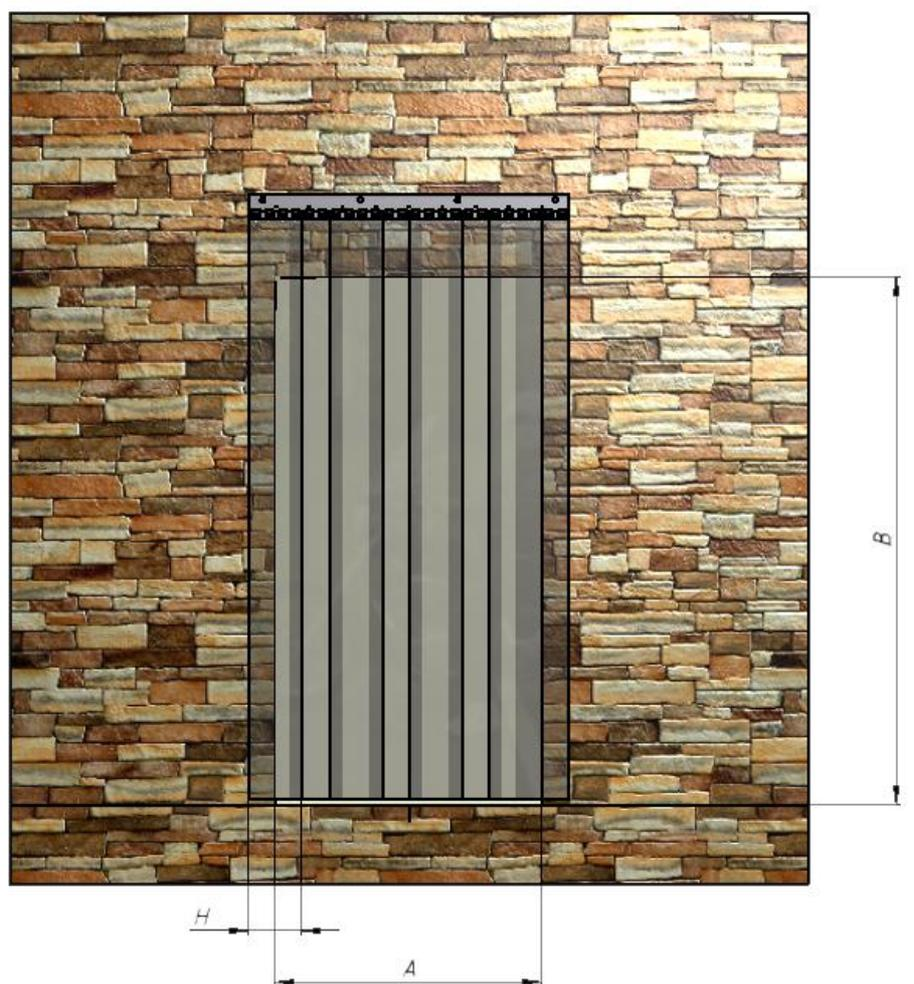
**Варианты перекрытия завес в зависимости от ширины полосы пленки.**
